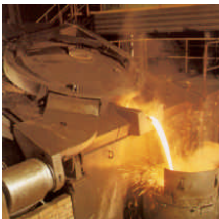
Induktions-Tiegelofen beim Abguss, Foto: ABB Automation Systems
