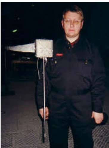
Messsonde an einer 4 m langen speziell gekühlten Rohrkonstruktion
