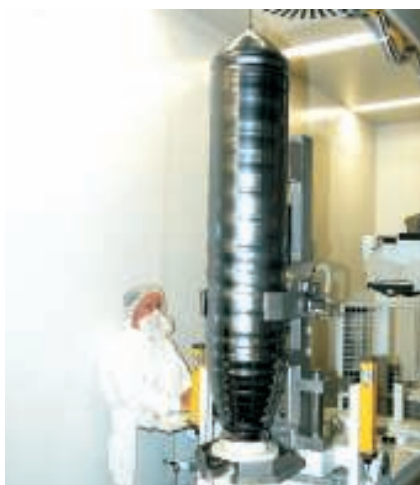
Im Czochralski-Prozess gezogener einkristalliner Silizium-Stab
