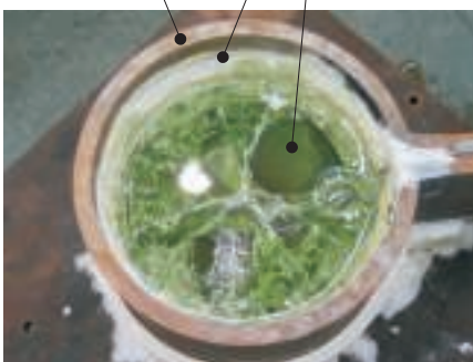
Erstarrtes Glas, induktiv geschmolzen im Induktortiegel
